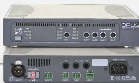
Le LD1.2 est le système de boucle à faible diaphonie de chez Opus Technologies. Ce dispositif intègre deux amplificateurs LD1.0, un kit de montage en rack et un cordon de liaison jack 6,35.
